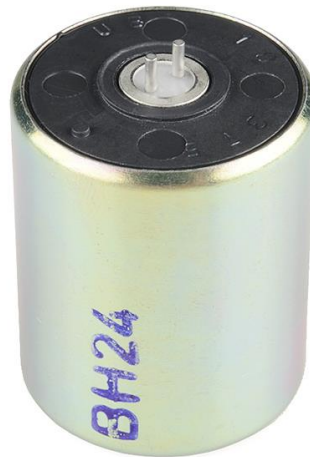
Figura 6. Senzorul de viteza utilizat (de tip geofon). Sensitivitate 28.8 V/m/s
